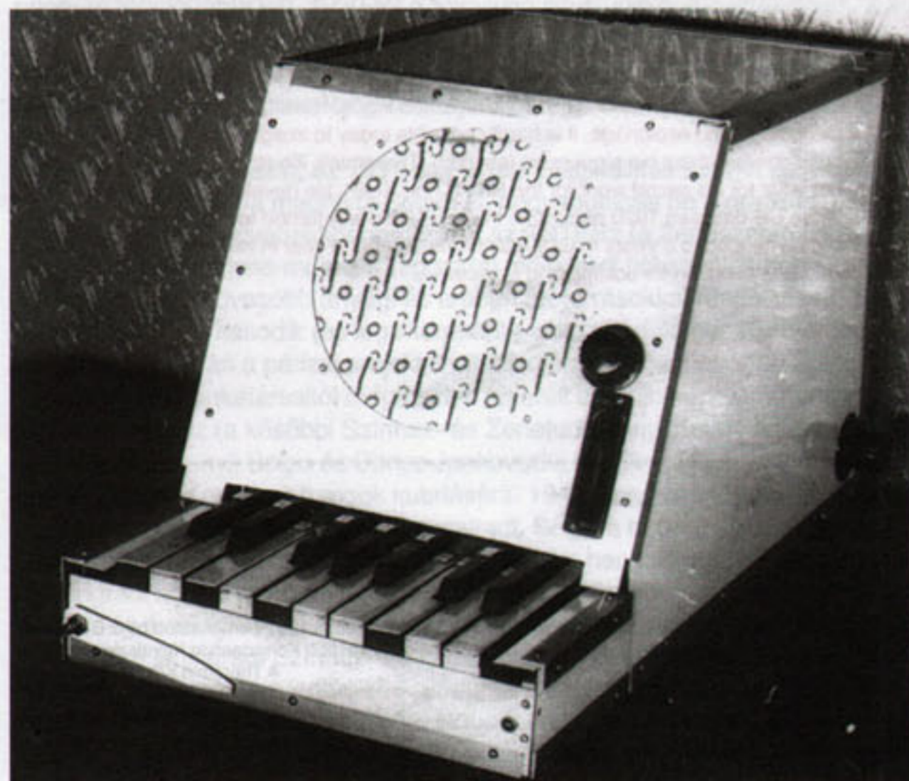
A ritmikon, az első ritmus-gép (1930). A billentyűkkel szinte végtelen számú bonyolult ritmust lehetett előállítani. A 3. verzió 1965-ben készült. A Theremin Központ archívuma The rhythmicon, the first rhythm machine (1930). By combining keys one could produce an almost infinite variety of complex rhythm patterns. The 3rd version, built in 1965. Theremin Center archive
